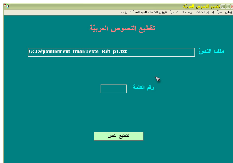
Figure 4. Capture d'écran : écran d'accueil du segmenteur montrant le chemin du fichier à segmenter, le bouton du lancement de la segmentation et le champ affichant le n° du mot graphique en cours de segmentation
